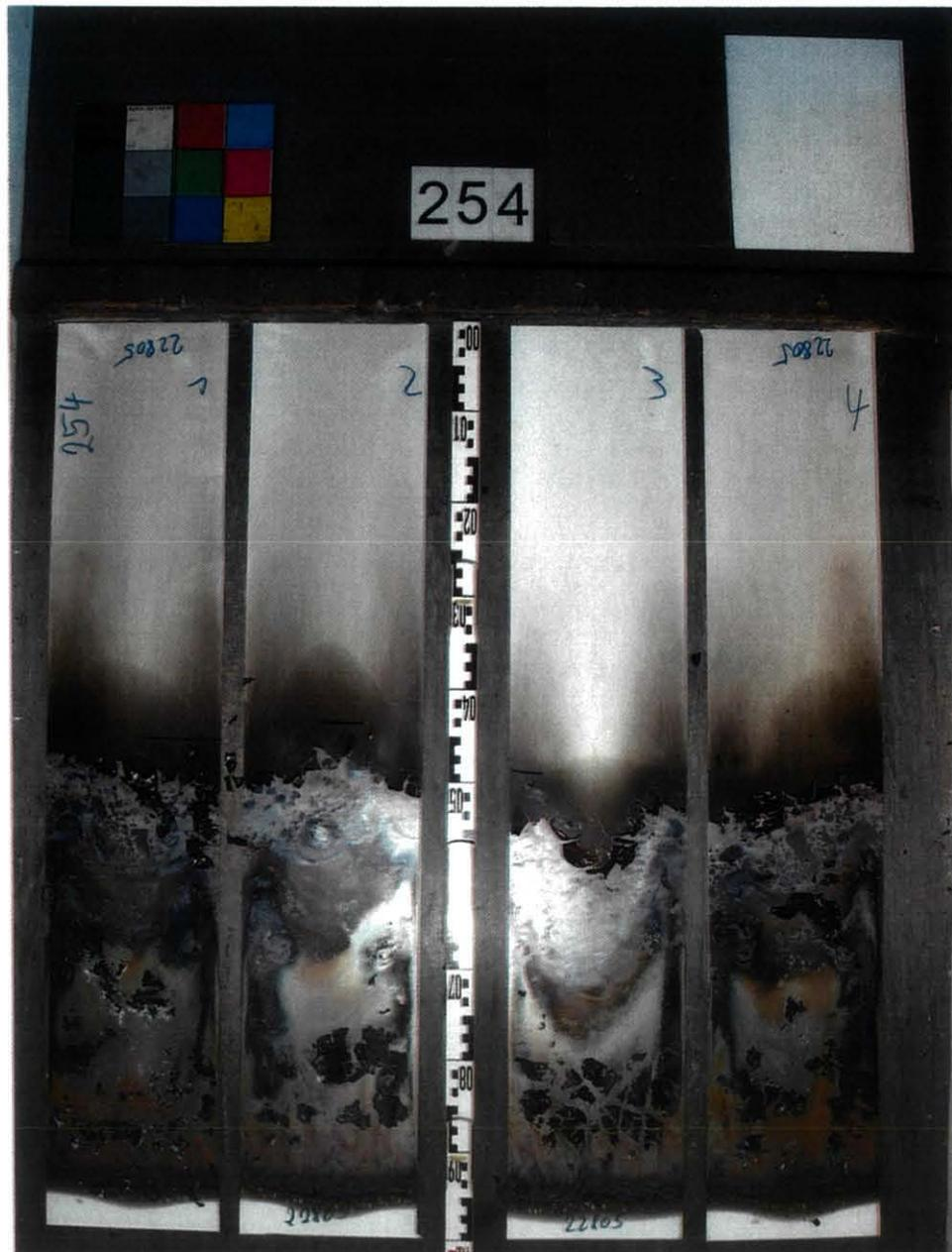
Bild 1: Aussehen des Probekörpers A2 nach dem Brandschachtversuch
