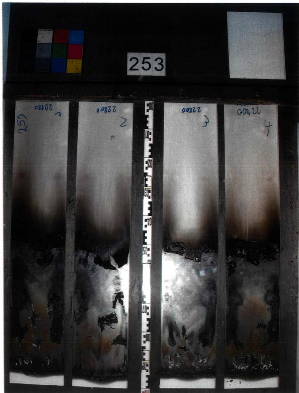
Bild 1: Aussehen des Probekörpers C1 nach dem Brandschachtversuch
