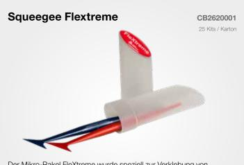
Der Mikro-Rakel FleXtreme wurde speziell zur Verklebung von Vinylgrafiken entwickelt. Enge Kurven und Kanten verklebt man am besten mit dem blauen (härteren) FleXtreme, damit das Auftragen nahtlos erfolgen kann. Der rote (weichere) FleXtreme unterstüzt die Verklebung ideal bei den schmalen Einbuchtungen eines Fahrzeugs. Das Set enthält 1 roten und 1 blauen FleXtreme.
