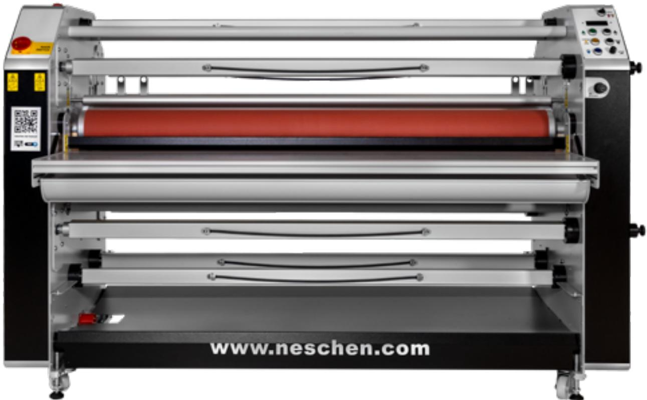
Die Neschen HotLam 1650 DoubleH ist die Maschine für erfahrene Profianwender. Sie besticht durch die Möglichkeit anspruchsvoller Heißeinschweißungen und einer hohen Arbeitsgeschwindigkeit. Materialüberstände lassen sich mit der integrierten Längsschnittlösung ganz einfach entfernen, um offene Klebefilme zu verhindern. Für eine bedienerfreundliche Bestückung sind vier der sieben Materialaufnahmen schwenkbar gelagert.
