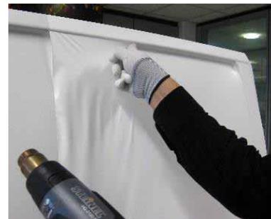
Nachdem die Folie in die Sicke geklebt wurde, wird die restliche Folie in die noch nicht applizierte Vertiefung verklebt.
