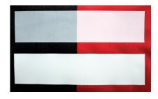
Viele Anwender vergessen, dass die meisten Trikotagen der Sportbekleidung aus Polyester bestehen und diese durch Sublimationsfarbe/-tinte eingefärbt werden. Während dem eigentlichen Transfer der Folien auf das Textil werden neben dem Heißschmelzkleber natürlich auch die Farbteilchen der Sublimationsfarbe aktiviert. Mit der Zeit wandern die Farbpigmente durch die zu Beginn noch hervorragend aussehende Flex-Folie.
